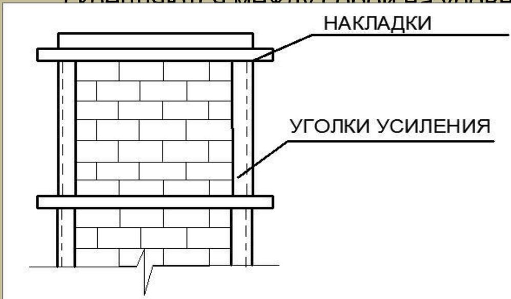
Пространство между уголками и накладкой зачеканивают раствором. Элементы обоймы заготавливают в мастерских, устанавливают вручную или при помощи подъемников. Элементы обоймы сваривают электродуговой сваркой и окрашивают масляной краской в два приема.
