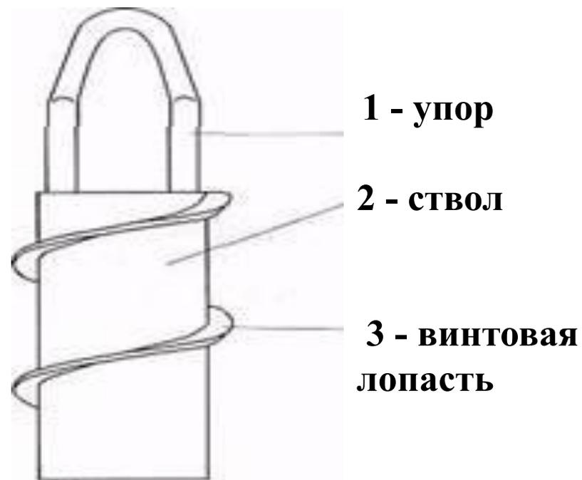
Рис. 1.2. Винтовой анкер сварной — ВАС (узколопастной).
