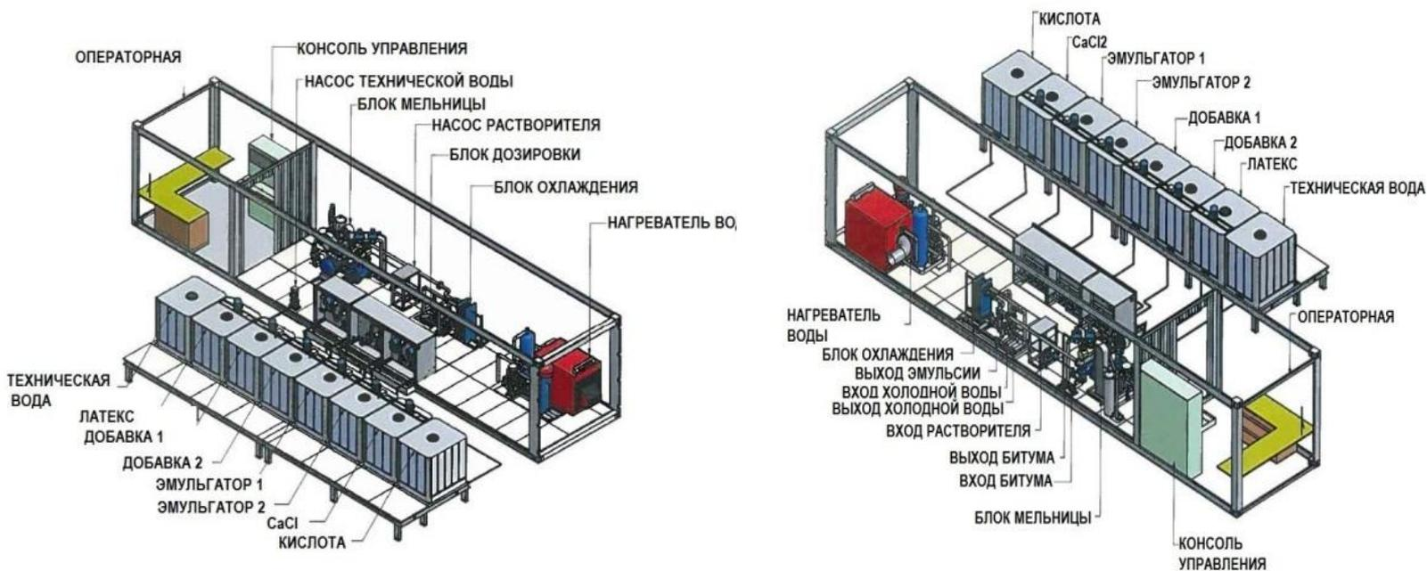
Установка занимает относительно мало места и смонтирована в мобильном исполнении в стандартном 40 футовом контейнере. Все поставляемое оборудование очень удобно в эксплуатации и позволяет использовать все необходимые химикаты, применяемые при производстве битумных эмульсий.
