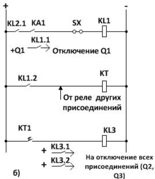
Рис. 21.4 Принципиальная схема пуска УРОВ с дополнительным контролем по току: а) схема цепей переменного тока; б) схема оперативных цепей
