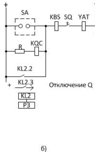
Рис. 21.5 Принципиальная схема пуска УРОВ с использованием реле положения "Включено"
