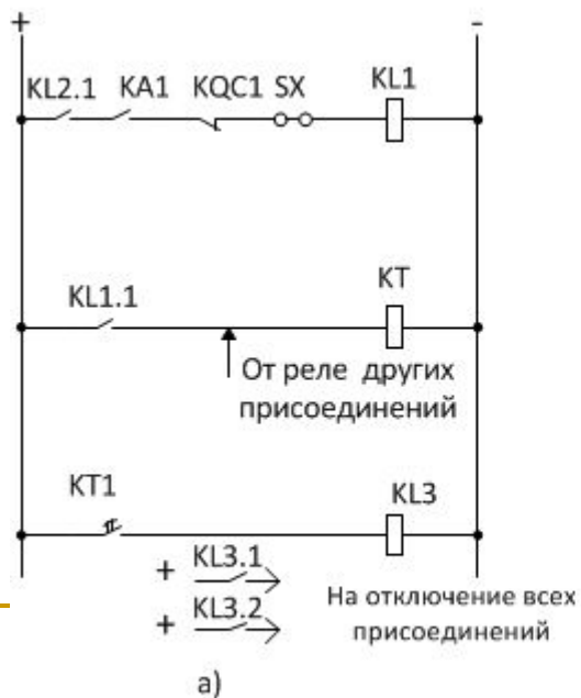
Рис. 21.5 Принципиальная схема пуска УРОВ с использованием реле положения "Включено"
