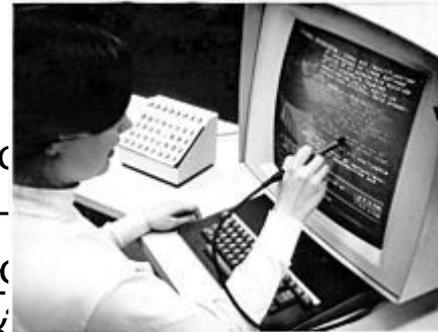
Манипулятор («мышка») — преобразователь движения в электрические сигналы. Мышь или манипулятор, преобразующий движения в электрические сигналы. Тачпад (англ. touchpad) — сенсорная панель (двух- или многопалочная сенсорная площадка), сенсорная панель — указательное устройство ввода, световое перо (англ. light pen) — один из инструментов ввода графических данных в компьютер, разновидность манипуляторов.
