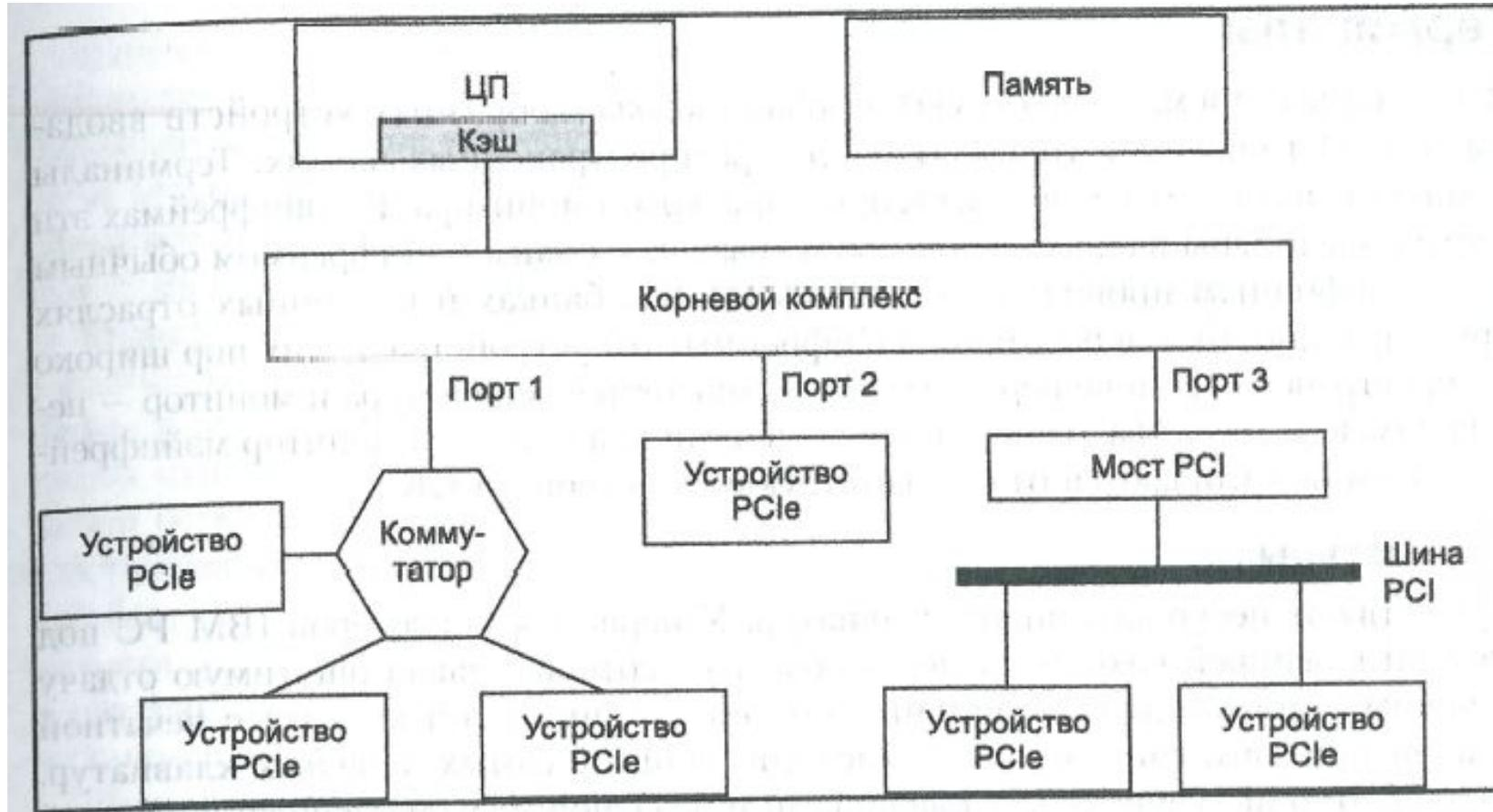
Шина PCIe представляет собой не шину, а одноранговую сеть, использующую разрядно-последовательные линии и коммутацию пакетов.
