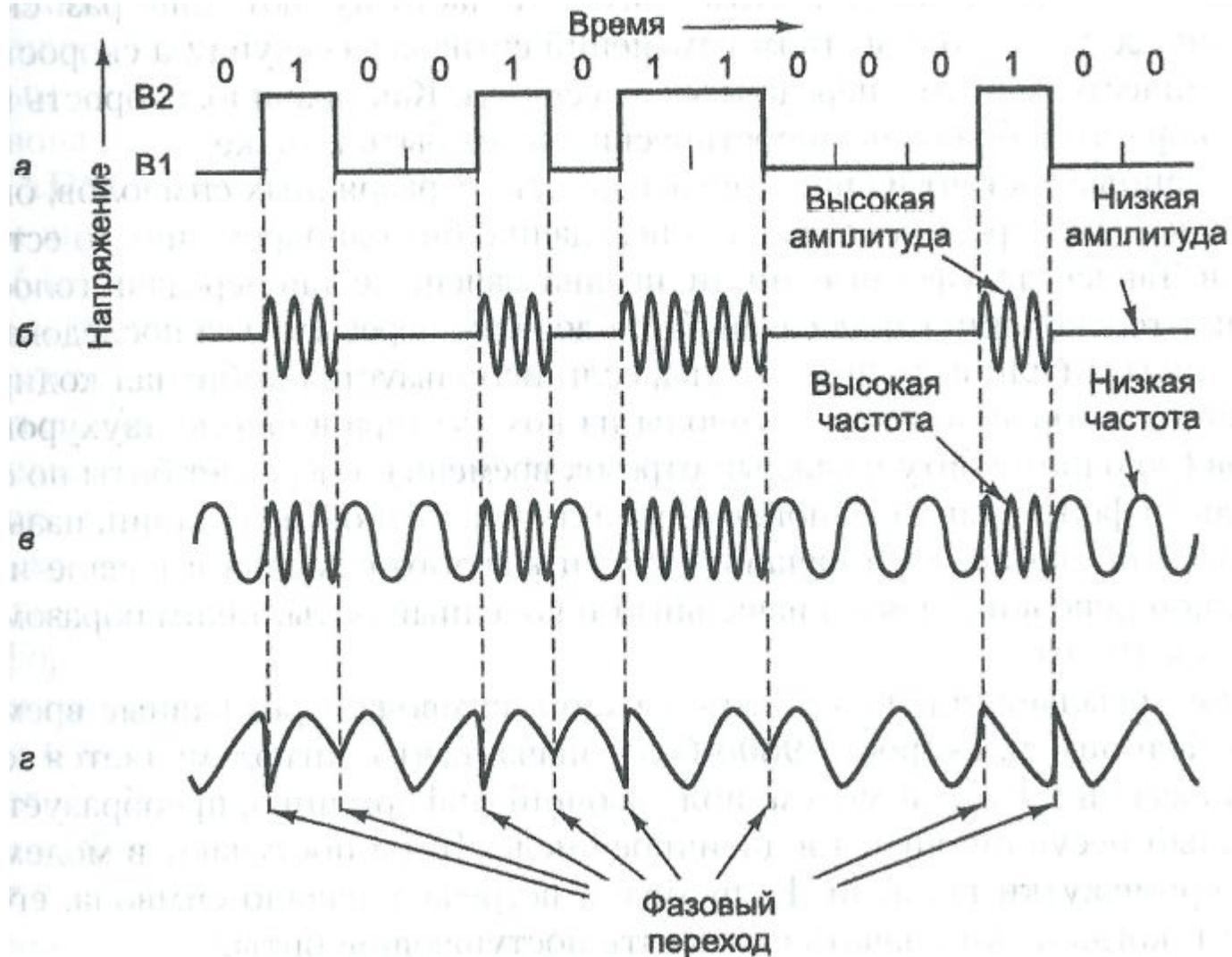
Последовательная передача двоичного числа 01001011000100 по телефонной линии:
