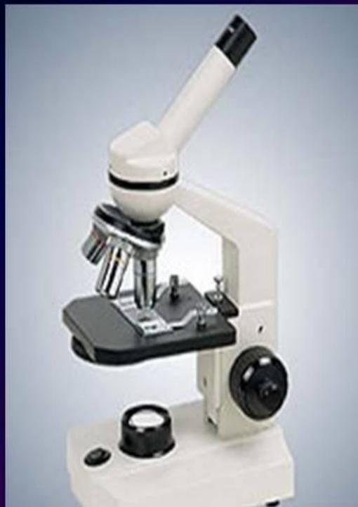
МИКРОСКОП (от микро... и греч. skopeo — смотрю), инструмент, позволяющий получать увеличенное изображение мелких объектов и их деталей, не видимых невооруженным глазом. Увеличение микроскопа, достигающее 1500-2000, ограничено дифракционными явлениями. Невооруженным глазом с расстояния наилучшего видения (250 мм) наблюдатель со средней остротой зрения может отличить одну мелкую частицу (или деталь объекта) от другой, лишь если они отстоят друг от друга на расстоянии  $\approx 0,08$  мм.
