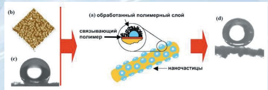
Рис. 7. Схема принципа действия новой ткани
