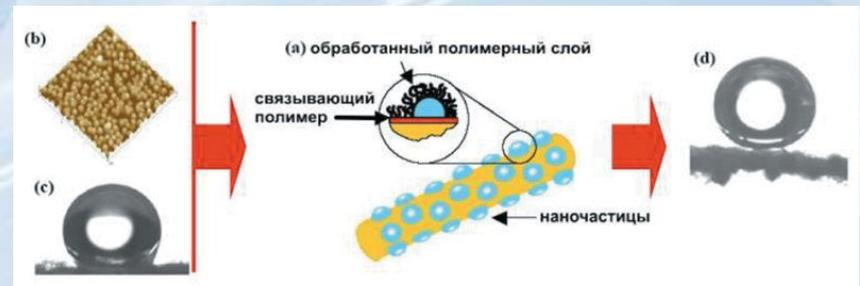
Рис. 7. Схема принципа действия новой ткани
