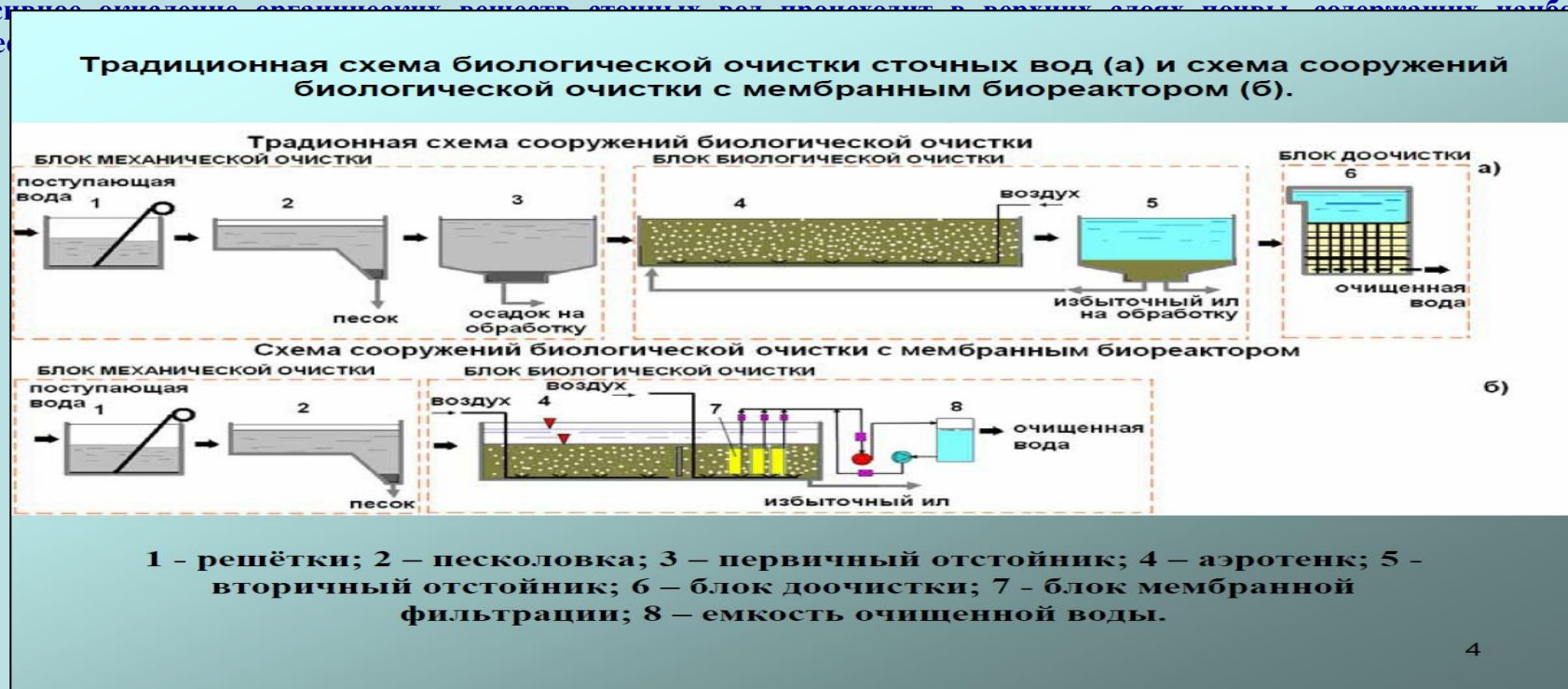
Рис.16. Технологическая схема станции с биологической очисткой сточных вод
