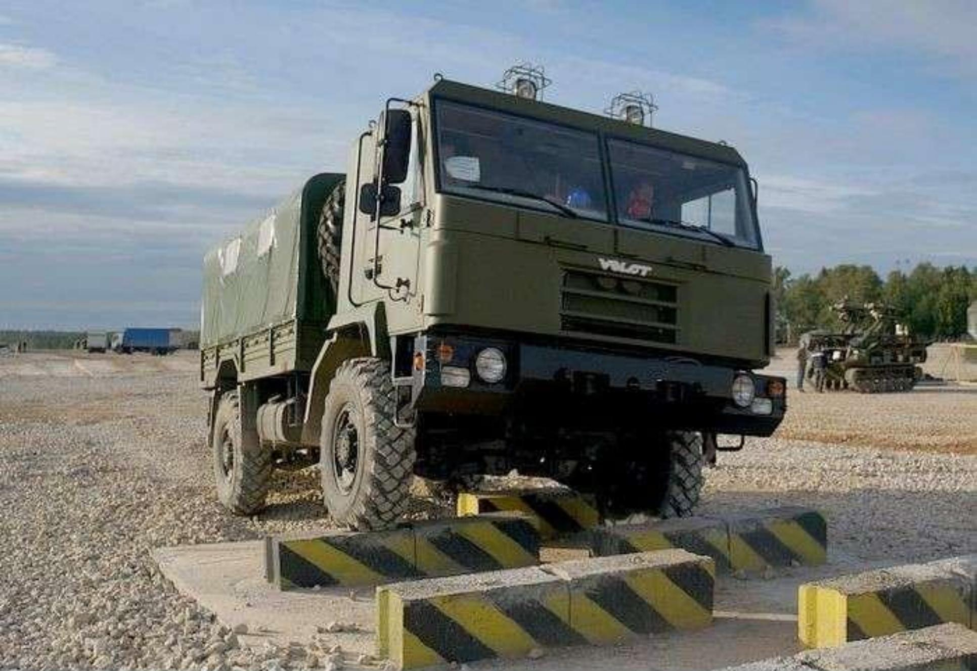
**МЗКТ-500200 (4x4): грузоподъемность - 3 т; двигатель ЯМЗ-53452 (215 л.с.)**
