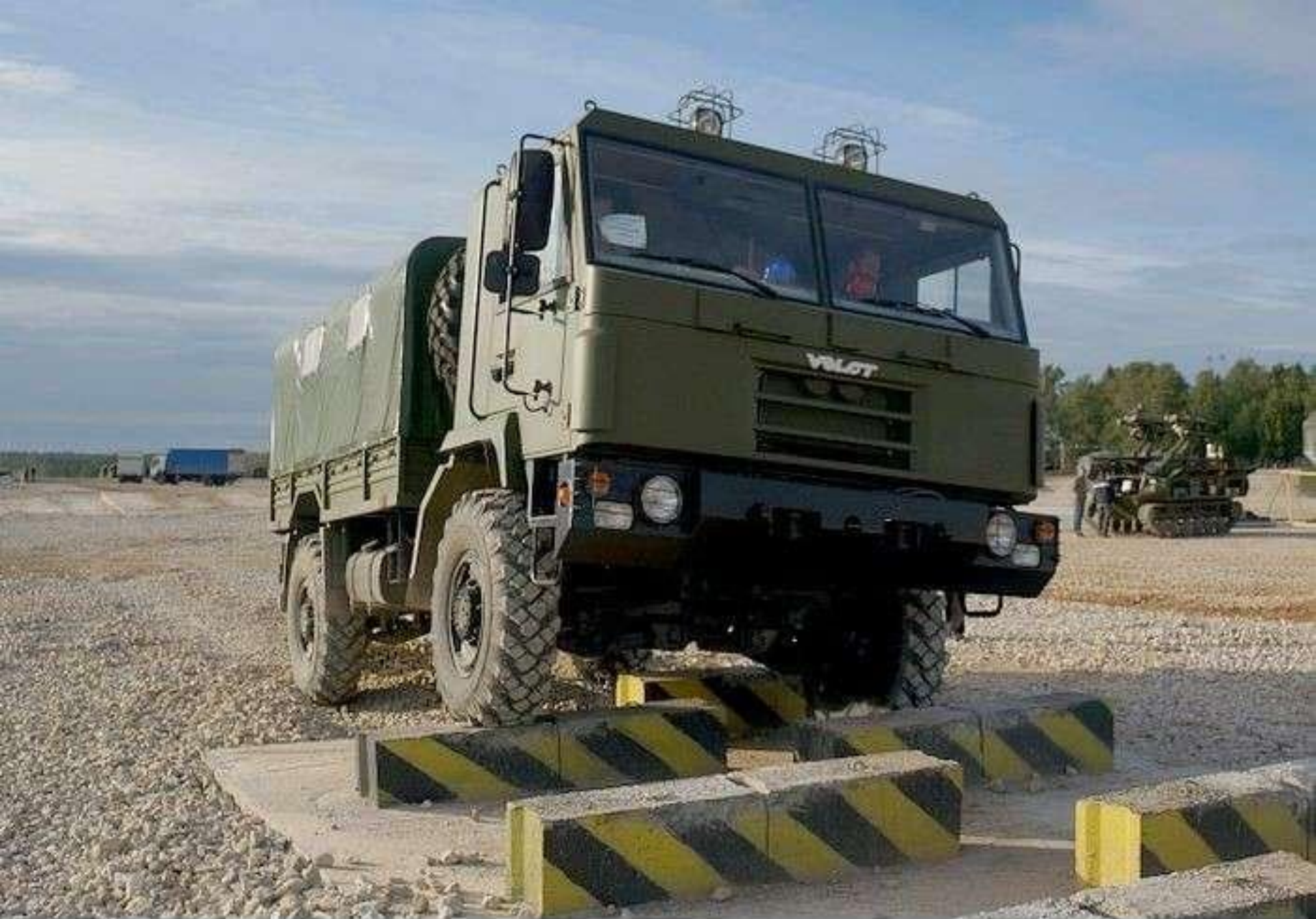
МЗКТ-500200 (4x4): грузоподъемность - 3 т; двигатель ЯМЗ-53452 (215 л.с.)
