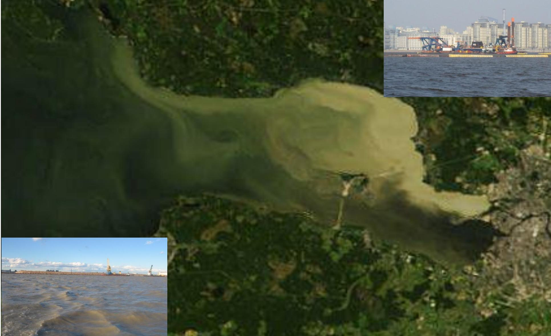
Распространение зоны повышенной мутности при строительстве МПП «Морской фасад» в Финском заливе (космический снимок, июль 2007 г.)
