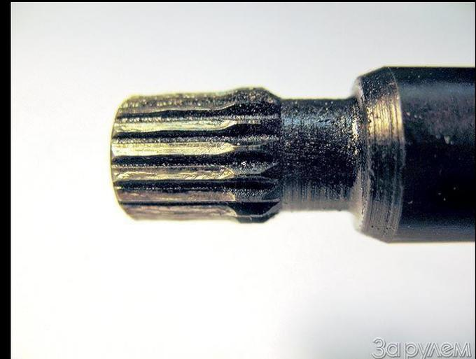
Детали данного класса восстанавливают в основном наплавкой, напылением, гальваническим наращиванием с последующей механической обработкой.
