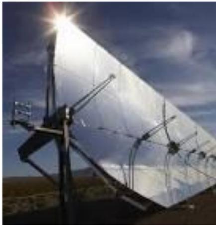
Концентрация солнечной энергии позволяет получать температуры до  $700^{\circ}\text{C}$ , которой достаточно для работы теплового двигателя. Например, параболический концентратор с диаметром зеркала 30 м позволяет сконцентрировать мощность излучения порядка 700 кВт, что дает возможность получить до 200 кВт электроэнергии. Для создания солнечных электростанций большой мощности (порядка 10 МВт) возможны два варианта: рассредоточенные коллекторы и системы с центральной солнечной башней
