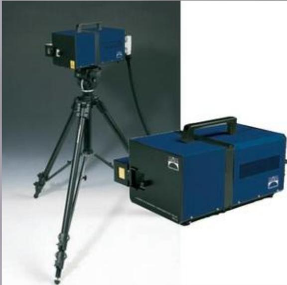
Данный прибор представляет собой бесконтактный датчик вибрации (бесконтактный вибропреобразователь), зондирующий поверхность объекта с помощью луча лазера
