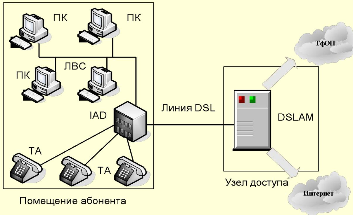
На абонентской стороне линии, идущие от телефонных аппаратов и, например, компьютеров, подключаются к IAD, преобразующему аналоговый сигнал телефонной связи в цифровую форму, объединяет его с данными, поступающими от компьютеров, и все это передает в виде цифрового высокочастотного сигнала на телефонную станцию.
