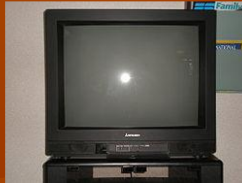
■ Телевизор на основе электронно-лучевой трубки
