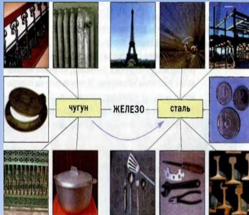
*«Чистое железо способно быстро намагничиваться и размагничиваться, поэтому его применяют для изготовления сердечников, трансфо-, мембраномоторов, электромагнитов и мембран микрофонов. Больше всего на практике используют сплавы железа - чугуна и стали»*
