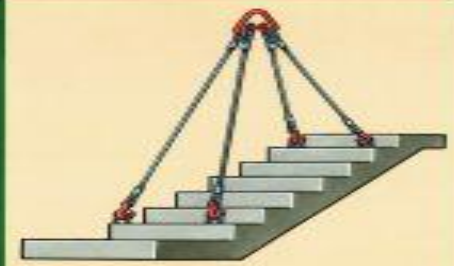
Лестничный марш. Четырехзвездчатый строп с вставками разной длины
