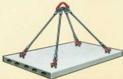
Плита. Четырехзвездчатый строп - за монтажные петли
