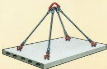
Плита. Четырехзвонковой строп - за монтажные петли
