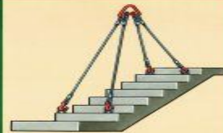
Лестничный марш. Четырехстоевый строп с вставками разной длины
