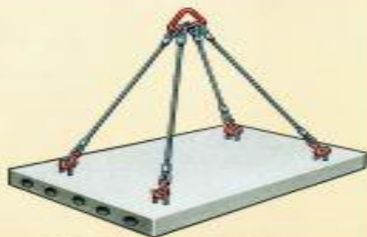
Плита. Четырехстоевый строп - за монтажные петли
