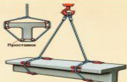
Балка. Для универсальных петлевых строп - в обхват петлями-удержателями
