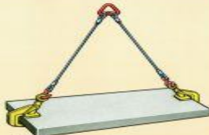
Плита. Двухзвездчатый строп с зафиксированными захватами - за край изделия
