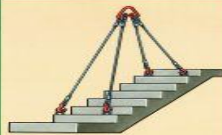
Лестничный марш. Четырехзвонковой строп с вставками разной длины
