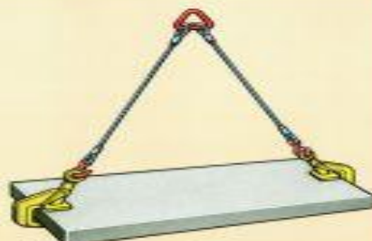
Плита. Двухзвонковой строп с зажимными захватами - за края изделия
