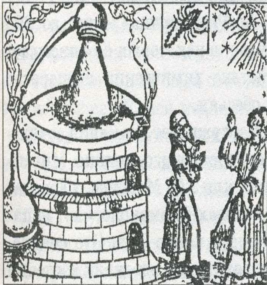
Печь для дистилляции (из сочинения Гебера)
