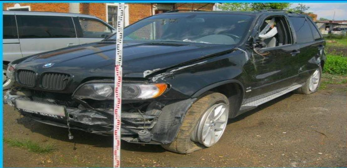
***Царапина, идущая параллельно оси автомобиля,*** указывает на боковой (скользящий) удар. Если она направлена вниз, значит, другой автомобиль резко сбавил скорость и просел; если царапина направлена вверх, это указывает на резкое снижение скорости (торможения) автомобиля, на котором осталась царапина.
