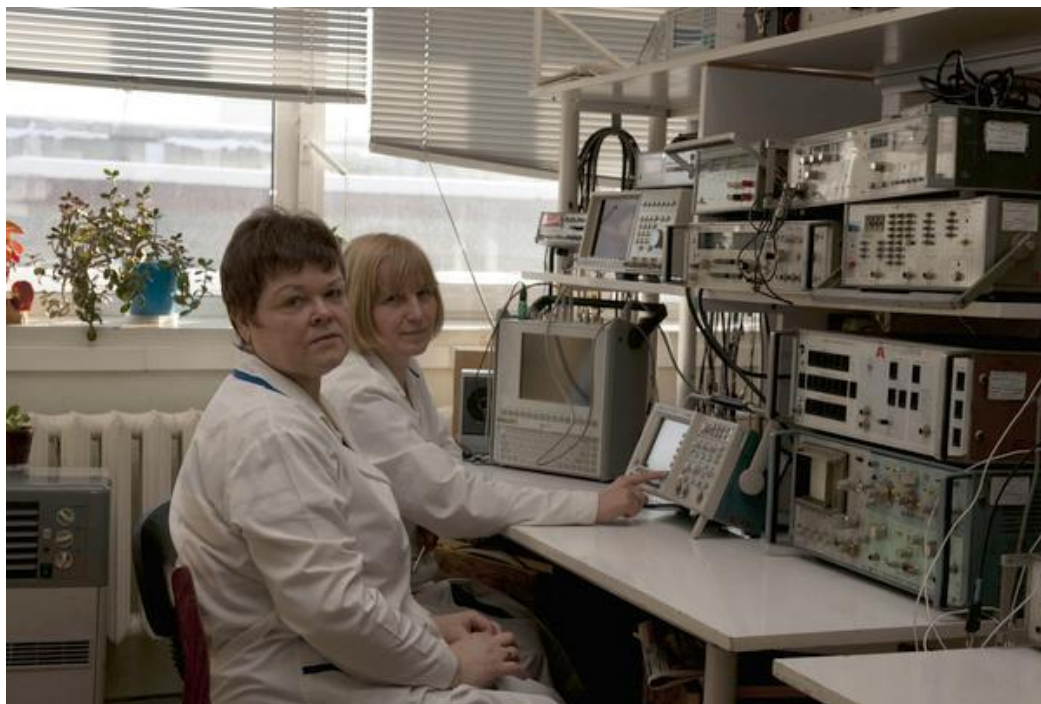
Рис 11 Рабочее место для проведения поверки и калибровки СИ радиотехнических величин
