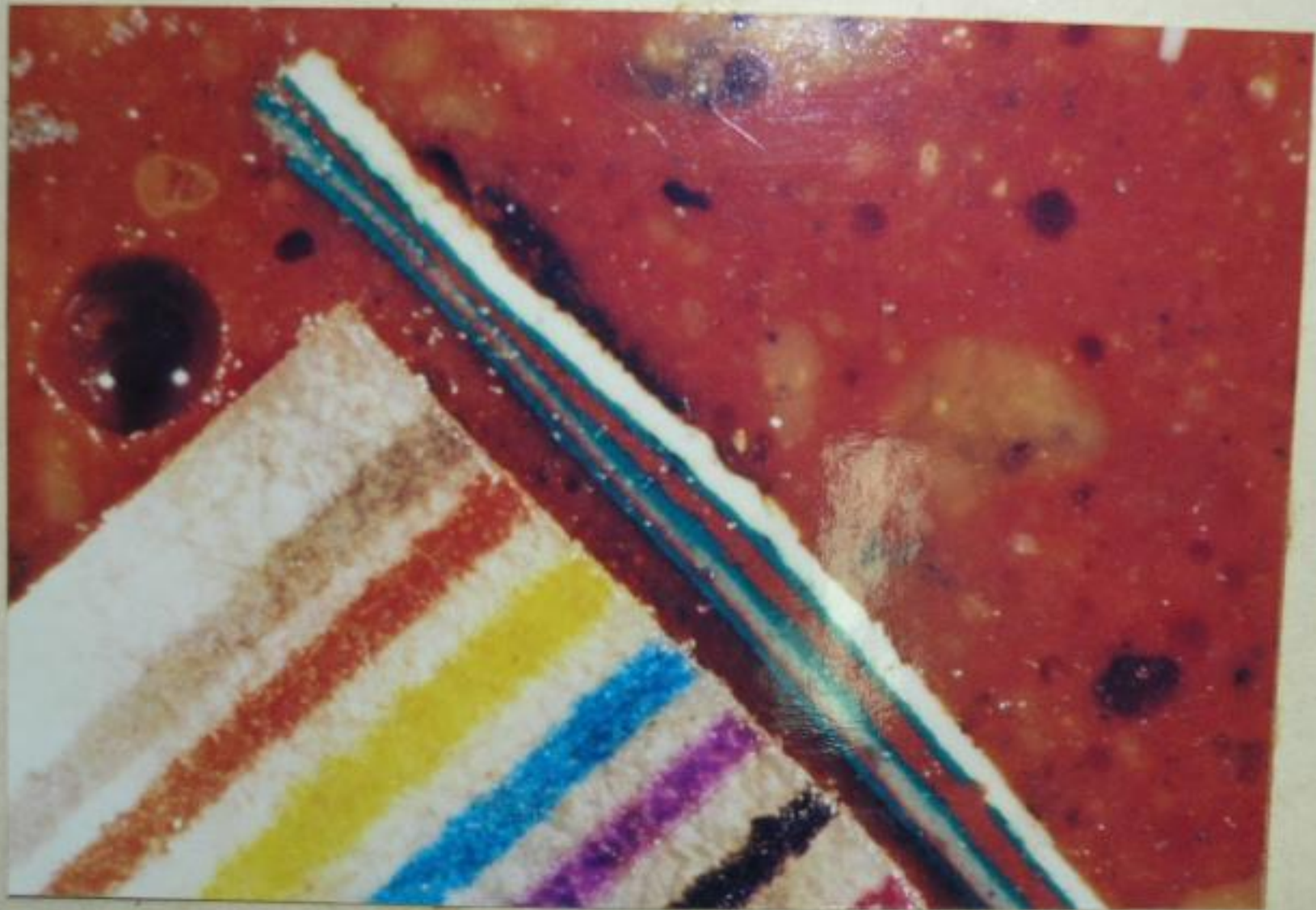
р 2. Поперечный шлиф семислойной конструкции ПСД
