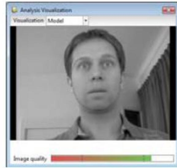
Также, реализован метод Active Appearance Model, с помощью которого можно создавать искусственную модель лица с учетом контрольных точек и деталей поверхности, и сравнивать ее с образцами, заложенными в память. Классификация происходит методами нейронных сетей с тренировочным набором в 2 000 фотографий.
