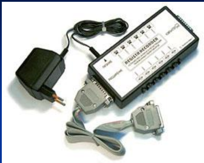
«Registr Recorder» (4-канальное устройство записи и регистрации телефонных переговоров)
